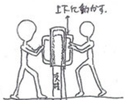
クイ打る君 筒状になっていて 支柱の上から鉄塊を 打ち込む
